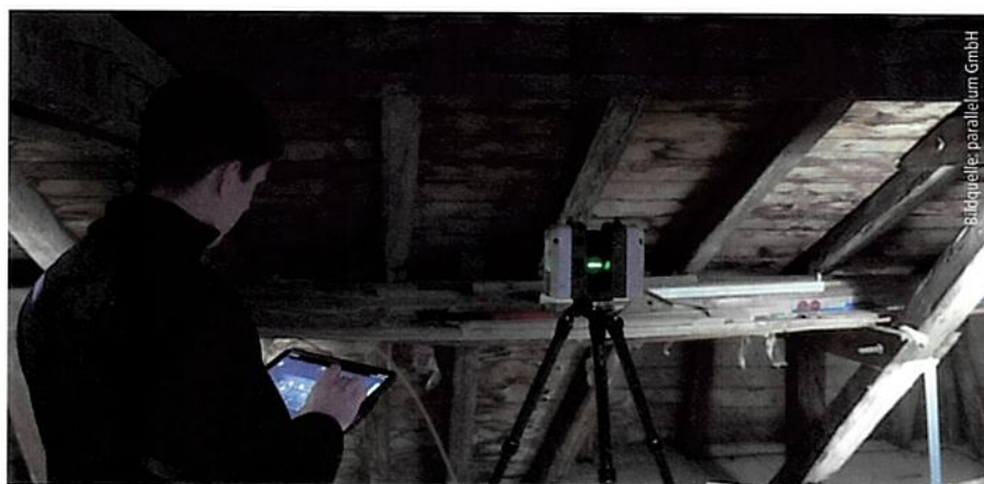
Abb. 5: Mit Tablet und 3D-Laserscanner erfolgt die Vermessung eines Dachgeschosses.
